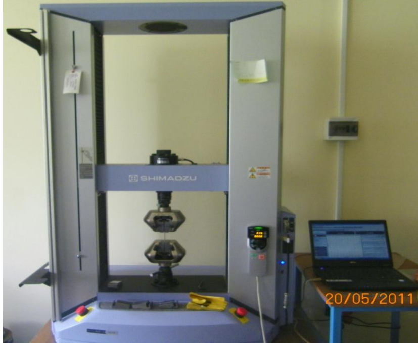
Şekil 2.12. Shimadzu marka 50 KN kapasiteli bilgisayar kontrollü nümerik çekme deney cihazı
