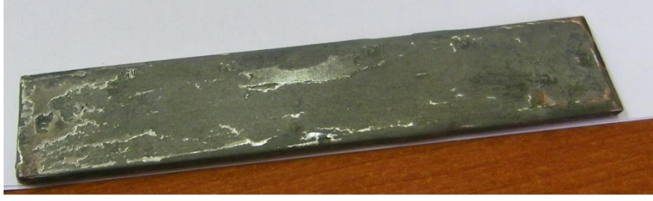
Şekil 3.9. AISI 304 paslanmaz çeliğin 1000 °C’de 6 saat süre ile Nanobor tozu ile yüzeyi alaşımlandırılan ve kaplama tabakası dökülen numunenin makro görünümü
