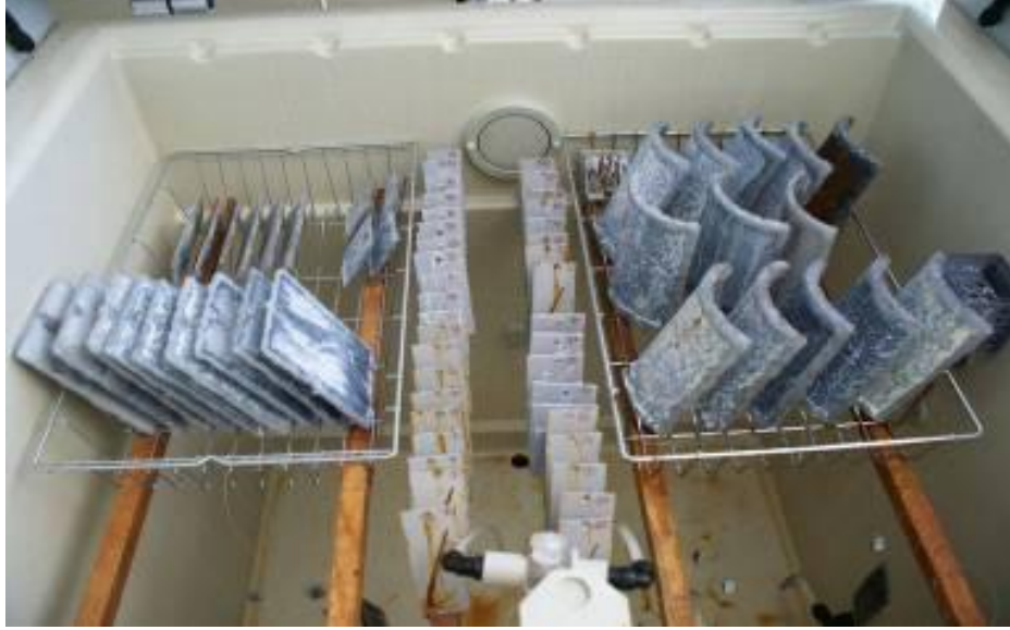
Şekil 2.19. Deney numunelerinin tuz püskürtme ünitesine yerleştirilme şekli
