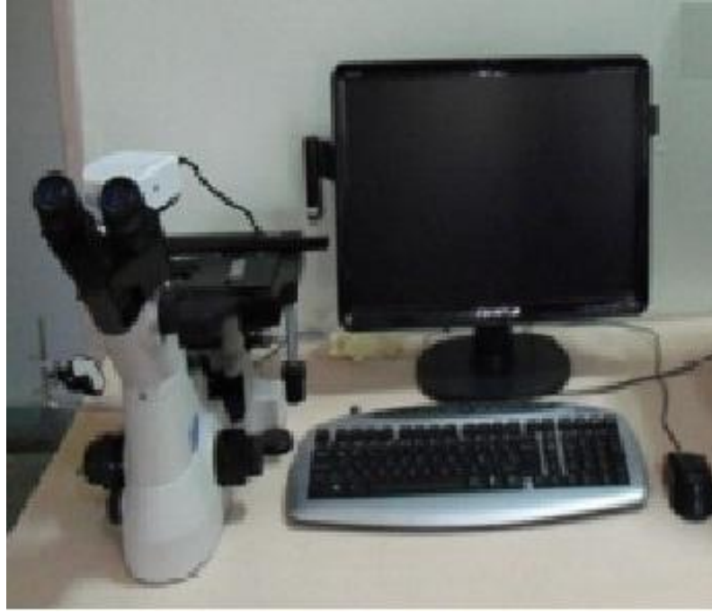
Şekil 2.8. Bilgisayar kontrollü Nikon MA100 optik mikroskop ve Clemex görüntü analiz sistemi
