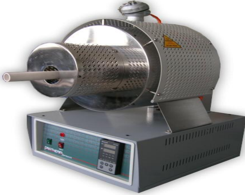
Şekil 2.1. Yüzey alaşımlandırma işleminde kullanılan Protherm PTF 12/38/450 boru tipi fırın
