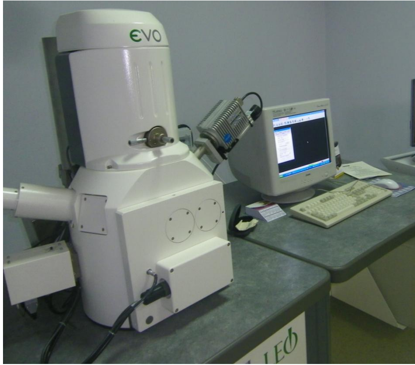
Şekil 2.7. EVO LEQ Scanning elektron mikroskobu (SEM) ve EDX analiz cihazı
