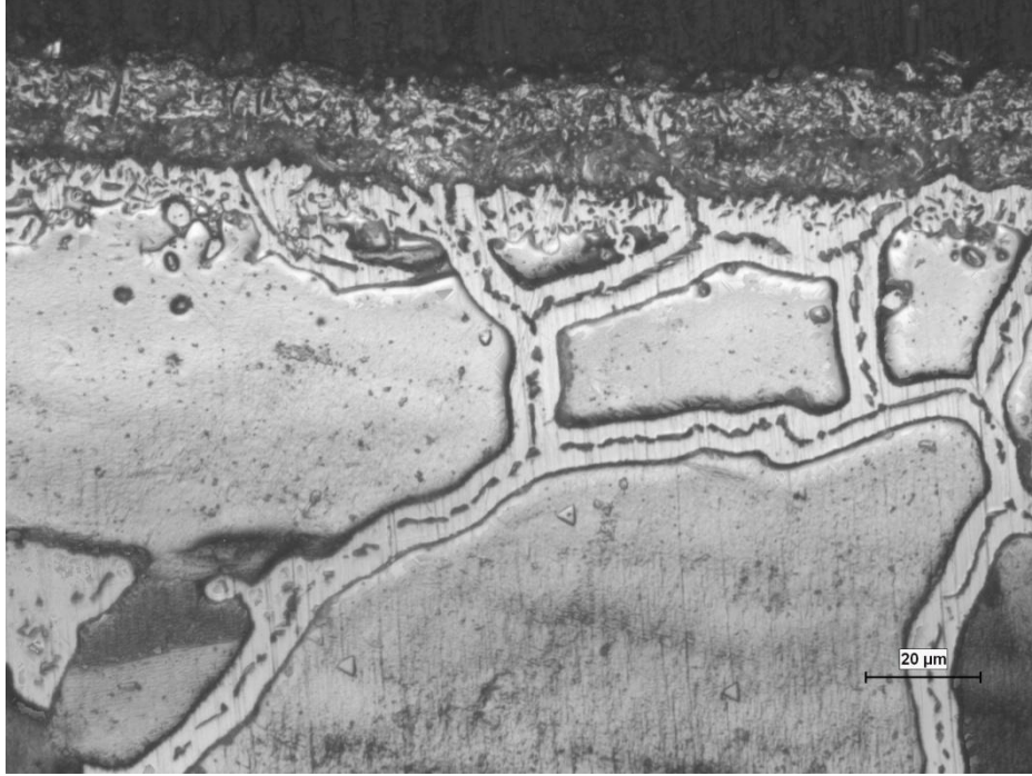
Şekil 3.6. AISI 304 paslanmaz çeliğin 1000 °C’de a) 2 saat b) 4 saat c) 6 saat sürede Nanobor tozu ile yüzeyi alaşımlandırılan numunelerin optik mikroyapı görüntüsü
