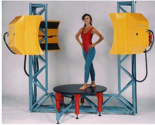
Resim 17 Cyberware vücut tarayıcı Model WBX (Dayık, 2008)
