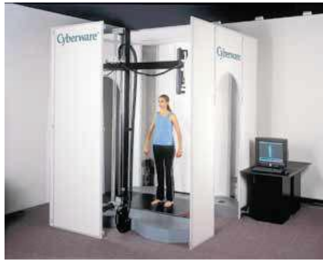
Resim 18 Cyberware vücut tarayıcı Model WB4 (Dayık, 2008)
