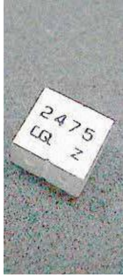
Şekil 3.1 Haberleşme sistemlerinde kullanılan dielektrik filtre.
