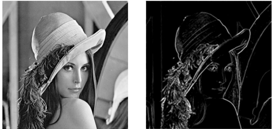
Şekil 2-8 Sobel operatörü kullanılarak kenar tespiti uygulaması (Zhengyang et al., 2010)
