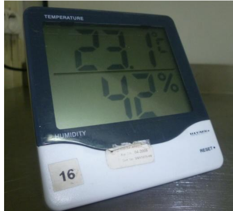
Şekil 3.6: Ortam nemi ve sıcaklıęını gsterir higrometre
