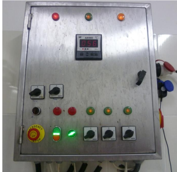
Şekil 3. 4: Evaporatörün ürün ve ısıtma yađı sıcaklık ayarı gibi parametrelerinin gözlemlendiđi ve müdahale edilebildiđi kontrol panosu
