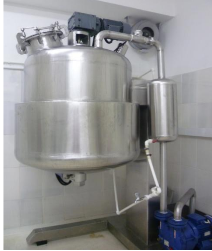
Şekil 3. 3: Deneylede kullanılan hammaddeye (herleye) önişlemin uygulandıđı evaporatörün görünüşü
