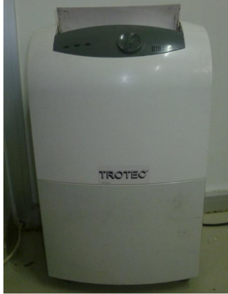
Şekil 3.7: Kabin tipi kurutuculara kuru hava sağlayan kurutma cihazı
