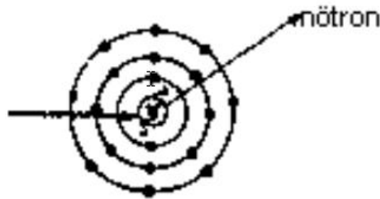
Şekil 2.9. : Fotodisintegrasyon olayının şematik gösterimi
