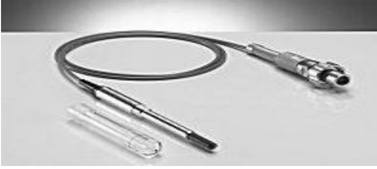
Şekil 3.4. : PTW marka 30010 - 30013 model iyon odaları
