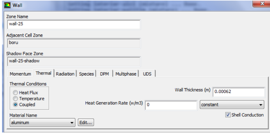
Şekil 7.24 : Boru çevresindeki ve yüzeylerdeki alüminyum folyoların tanımlanması
