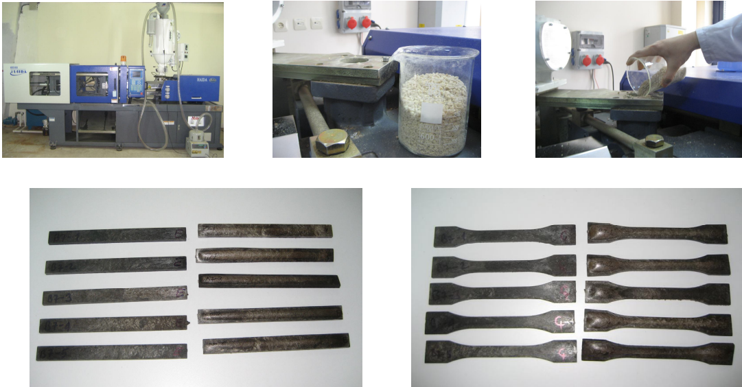
Şekil 3.7. Enjeksiyon Makinesinde Köpüksüz ve Köpüklü olarak Eğilme ve Çekme Örneklerinin Üretilmesi
