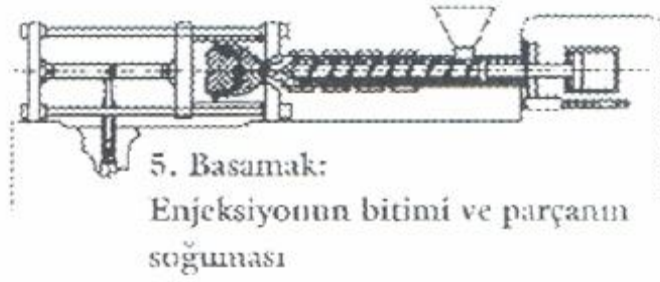
Şekil 1.20. Enjeksiyon Bitimi ve Parçanın Soğuması (Tuğ ve Haksever, 2005).
