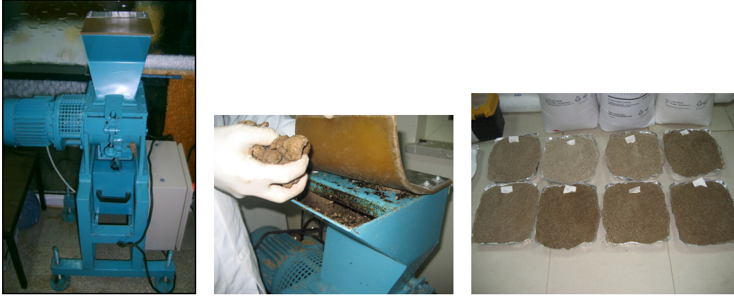
Şekil 3.6. Kırıcıda Ekstruder Çıktısının Pelet Haline Getirme İşlemi
