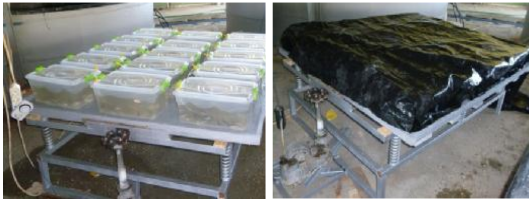
Şekil 3.5. Balık taşıma denemesinde kullanılan el yapımı platform ve deneme görüntüsü.
