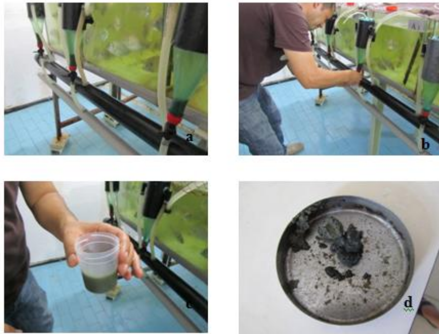
Şekil 3.3. a: Ke-TUF dışkı toplama sisteminde biriken dışkılar, b: Dışkıların numune kabına alınması, c: Numune kabına alınmış dışkı, d: Suyu alınmış dışkı
