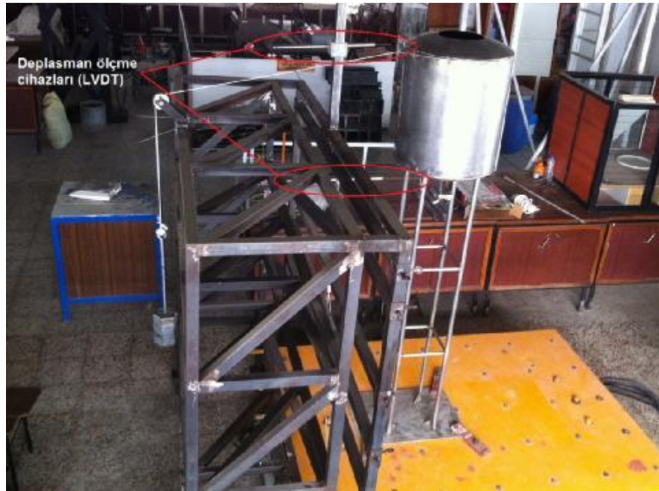
Şekil 4.2. Statik deneyde su deposunun ve kullanılan yüklerin görünümü
