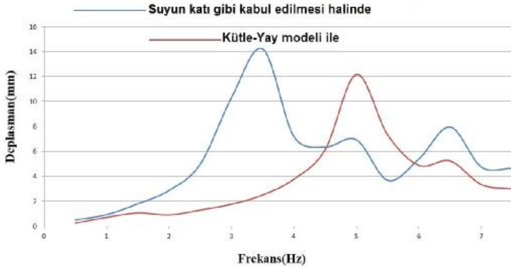
Şekil 4.36. Ayak tepe noktası rölatif maksimum yatay deplasmanın frekansa göre değişimi
