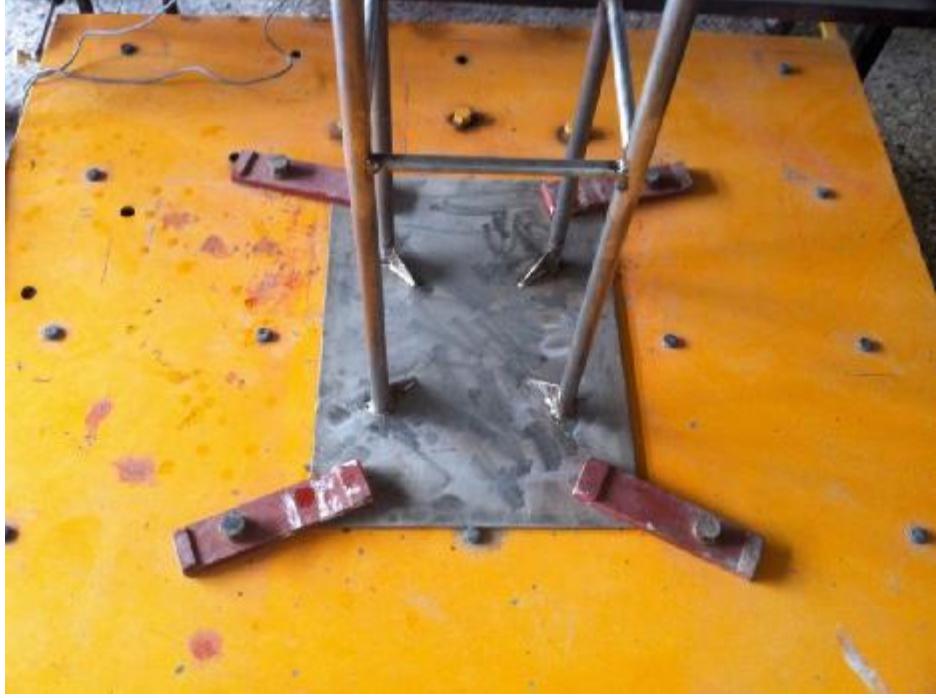
Şekil 3.19. Ayak mesnet noktalarına ait detay ve model-tabla bağlantısı
