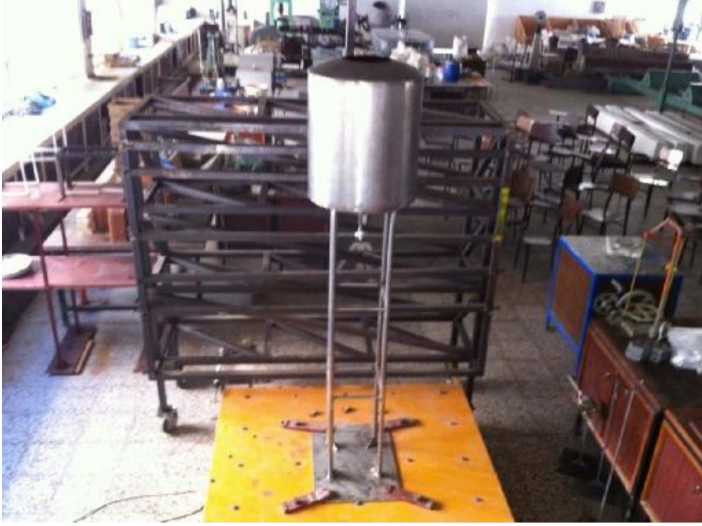
Şekil 3.21. Su deposunun deneye hazır hali
