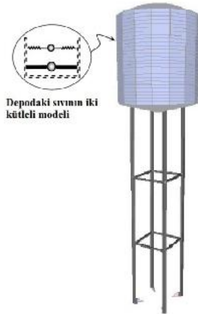
Şekil 3.14. Suyu modellemek için kullanılan yöntem
