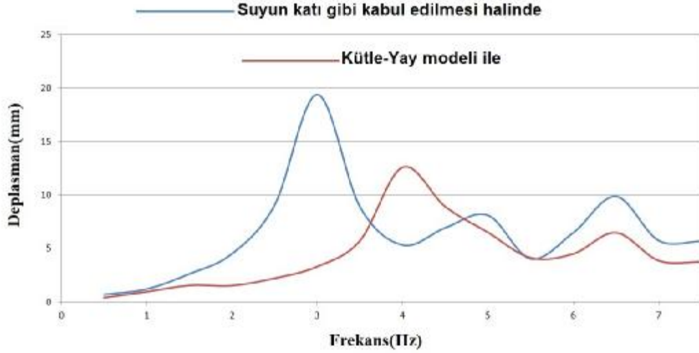
Şekil 4.34. Ayak tepe noktası rölatif maksimum yatay deplasmanının frekansa göre değişimi
