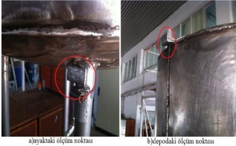
Şekil 3.20. Su deposundaki ayak ve deponun deplasman ölçüm noktaları
