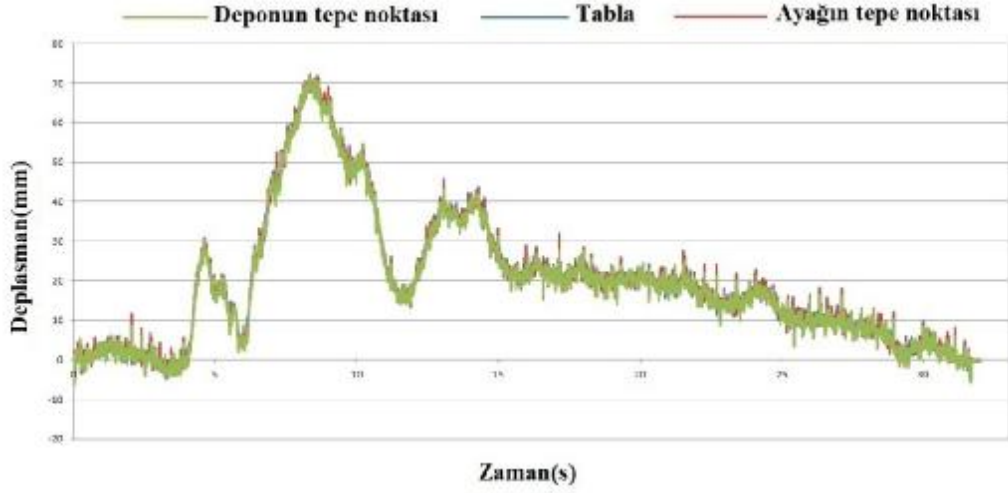
Şekil 4.19. Ölçeklenmiş Düzce Depremi (1999) kayıtlarının su deposu boşken uygulanması sonucu elde edilen yatay depo ve ayağın tepe nokta deplasmanları ve tabla deplasmanları
