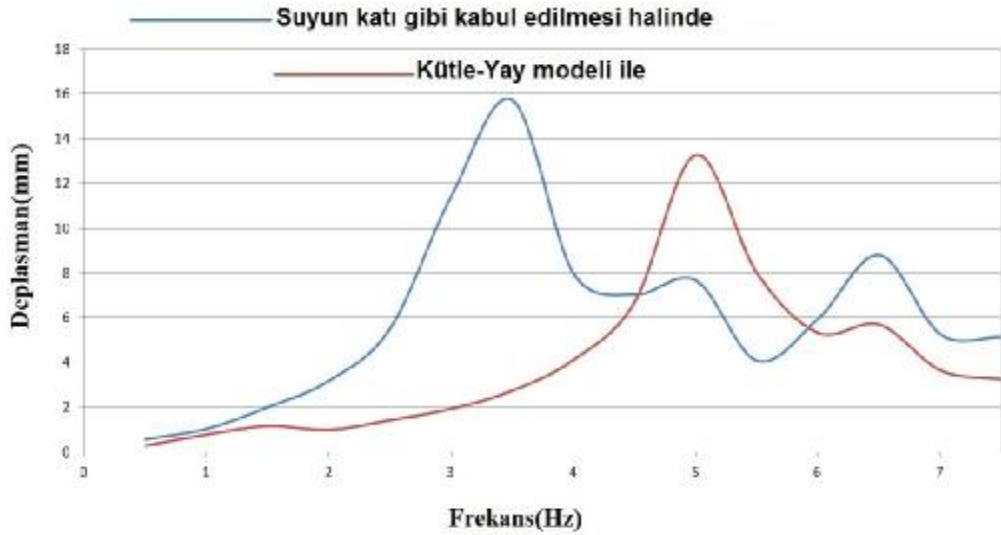
Şekil 4.37. Depo tepe noktası rölatif maksimum yatay deplasmanın frekansa göre değişimi
