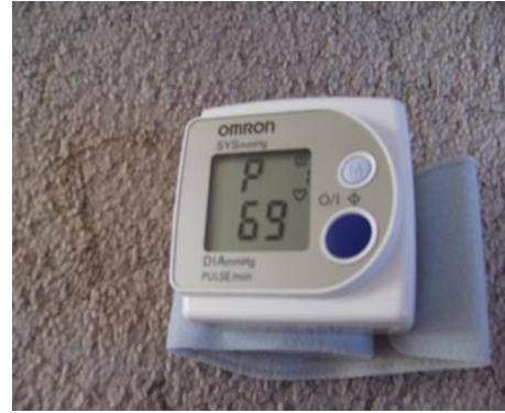
Resim 3. 2. 4. 1. Omron RX-3 marka tam otomatik tansiyon aleti
