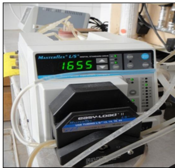
Şekil 3.8. Çamur uzaklaştırmada kullanılan pompa
