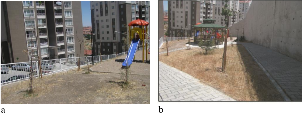
Şekil 7.80 Alandaki bitkilerin dikimi a. Bitkiler dikim şartlarına uyulmadan yapıldığından kökleri dışarıda kalmıştır (Erkişi 2012). b. Bitkilerin dikildiği yerler de bitkisel toprak neredeyse bulunmadığından bitkilerde kurumalar olmuştur (Erkişi 2012).
