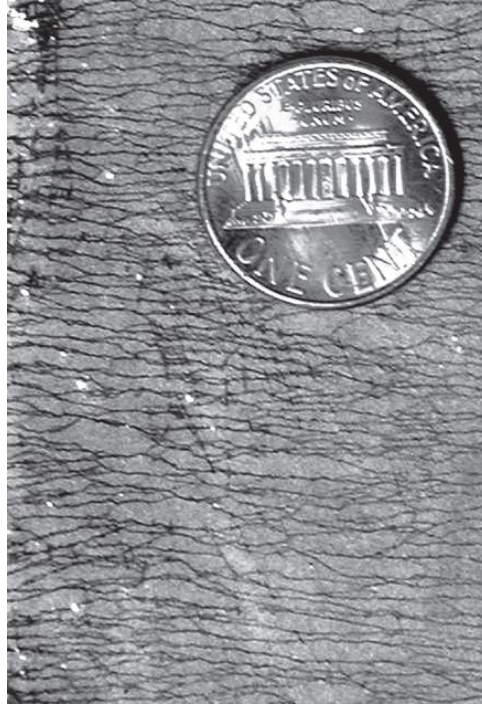
Şekil 2.5: PVA lifli çimento esaslı kompozitte aksenal çekme altında mikro çatlak oluşumu [21].
