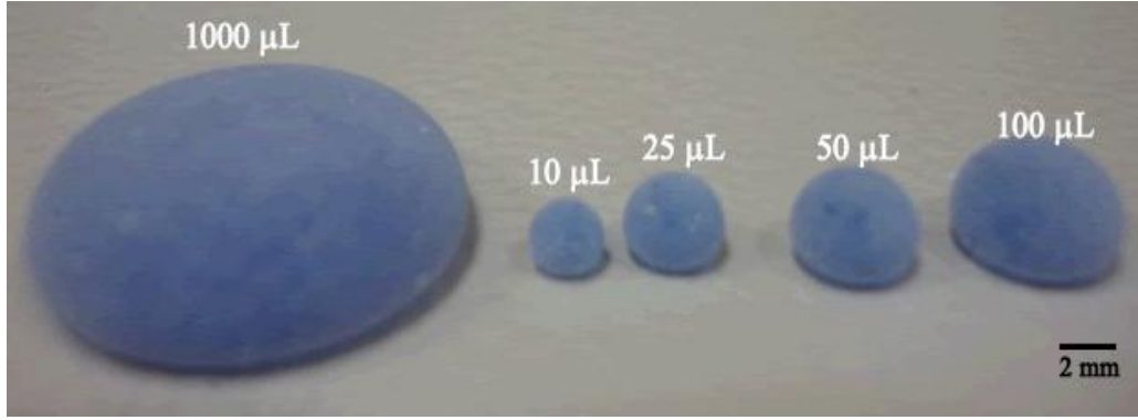
Şekil 10.12. Sıvı bilye yüksekliğinin sıvı bilye hacmi artışı ile büyümesi
