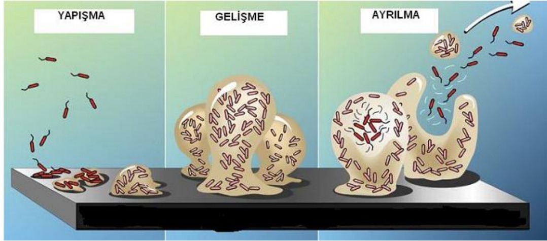
Şekil 2.8. Biyofilm oluşumunun şematik görünümü (Sakugari and Kolter, 2007)
