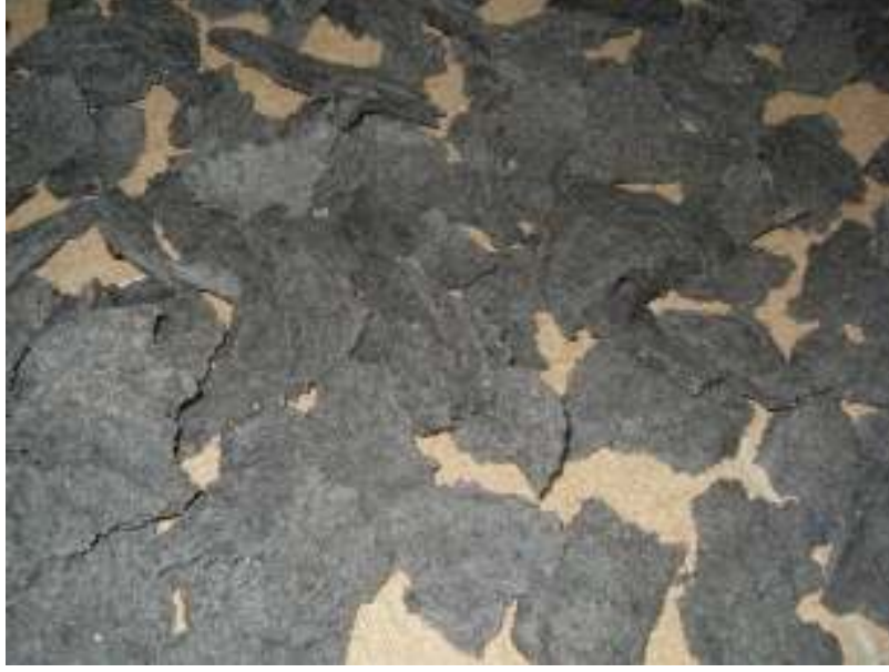
Şekil 4.11 : Kırma işlemi öncesi malzemenin küçük parçalara ayrılması.
