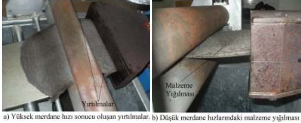
Şekil 4.10 : Merdane hızının karma malzemeye etkisi.
