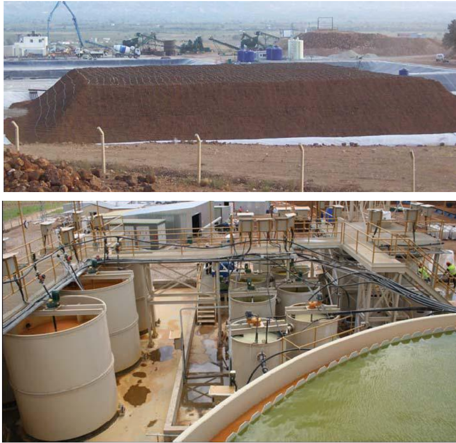
Şekil 4.7: Manisa-Çaldağ pilot yığın liçi uygulaması, a) Yığın b) Liç tankları [20].
