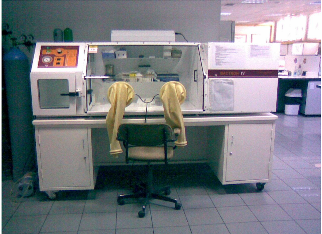
Şekil 3.1. Anaerobik kabin (GATA Tıbbi Mikrobiyoloji AD. Bakteriyoloji Laboratuvarı)
