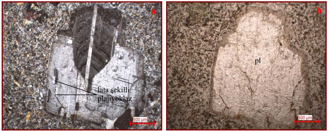
Şekil 4.28.a. İgnemsi amfibollü mikrodiyoritporfirlerde mantolanmış ve lata içeren zonlu plajiyoklaz fenokristalinin polarizan mikroskop altında çift, b. tek nikol görüntüleri (örnek:T08–106)
