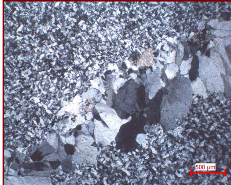
řekil 4.20 Kuvarsolit ve bunları kesen ikincil kuvars mikro-damarcıklarının mikrofotografı ( rnek, K08-82)
