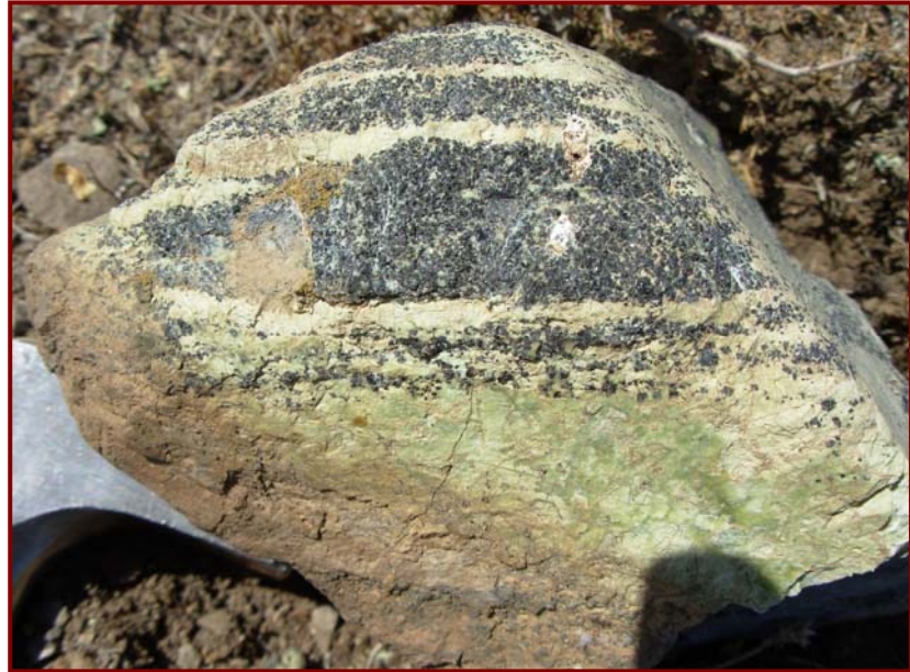
Şekil 3.13 Peridotitlerde yersel olarak gözlenen kromit bantları (Yörükkaracaören GD'su Söğütlüçeşme mevki)
