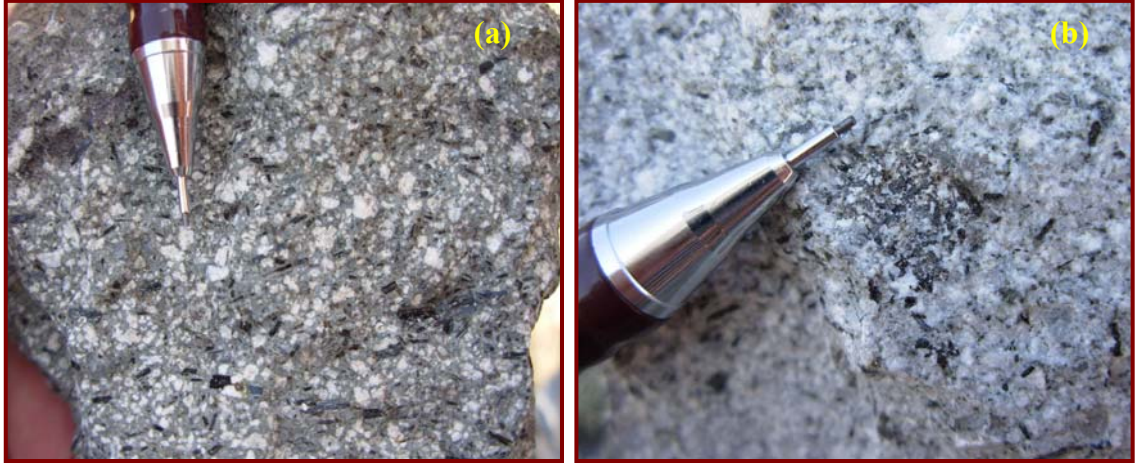
Şekil 3.33.a. Dioritporfirlerin makroskobik görüntüsü, b. Yörükkaracaören diyorit porfirleri içerisinde gözlenen magmatik segregasyon anklavları (Yörükkaracaören GD'su Söğütlüçeşme mevki)
