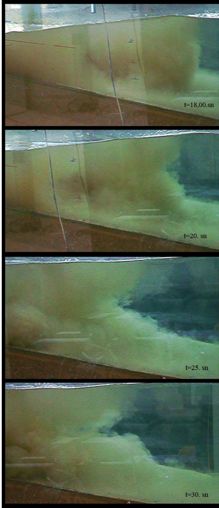
Şekil A.3 : H=13,68 cm'lik tsunami tipi dalga etkisinde sediment bulutunun oluşması ve şev üstünde ilerlemesi.
