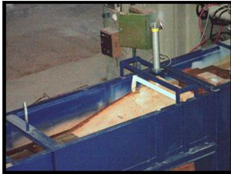
Şekil 4.3 : Dalga paleti (piston yukarı konumunda).
