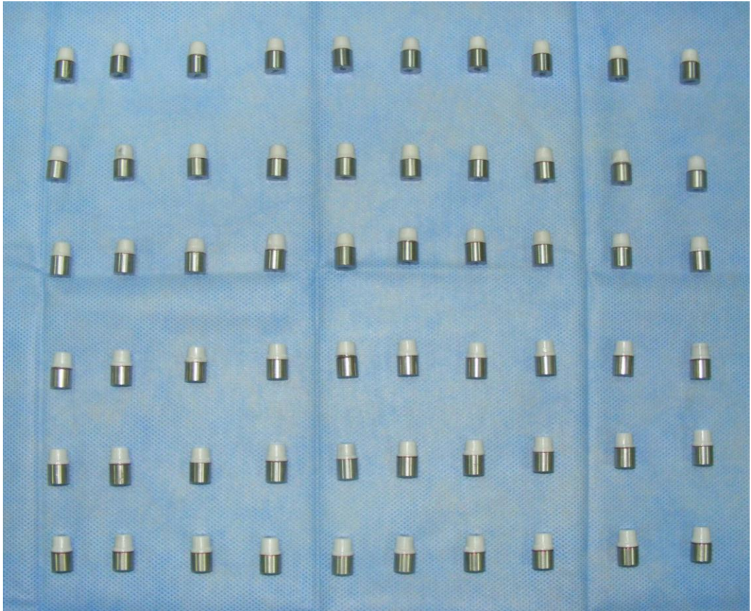
Şekil 3.2. HIP ve NON-HIP zirkonia örnekler
