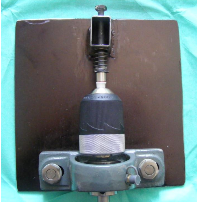
Şekil 3.6. Marjinal aralık ölçümlerinde kullanılan düzenek
