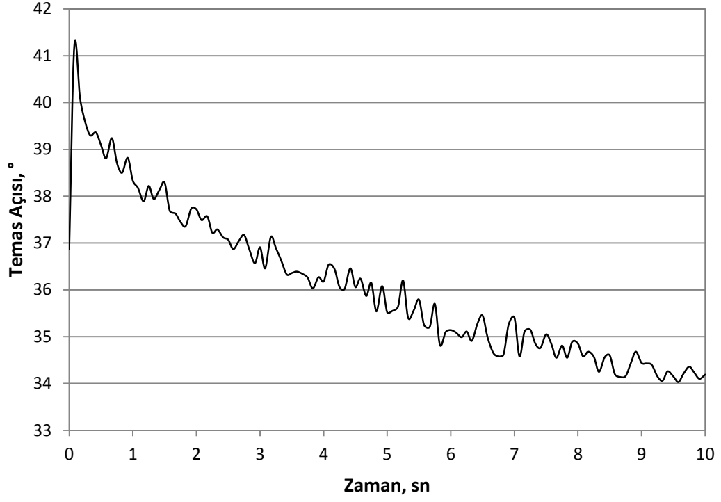
Şekil 6.22 Temiz UP150 membranının temas açısı ölçümü
