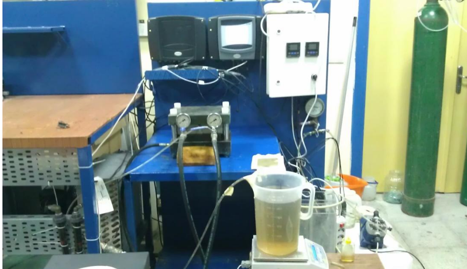
Şekil 5.2 Çapraz akışlı flat-sheet membran sistemi
