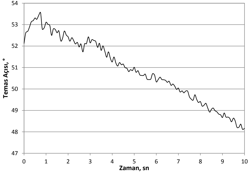
Şekil 6.31 Dengeleme havuzundan alınan numunelerin arıtılması sonucunda kirlenen NF270 membranının temas açısı ölçümleri
