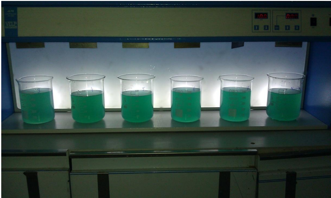
Şekil 5.4 Sülfat çöktürme işleminde kullanılan düzenek ve numuneler
