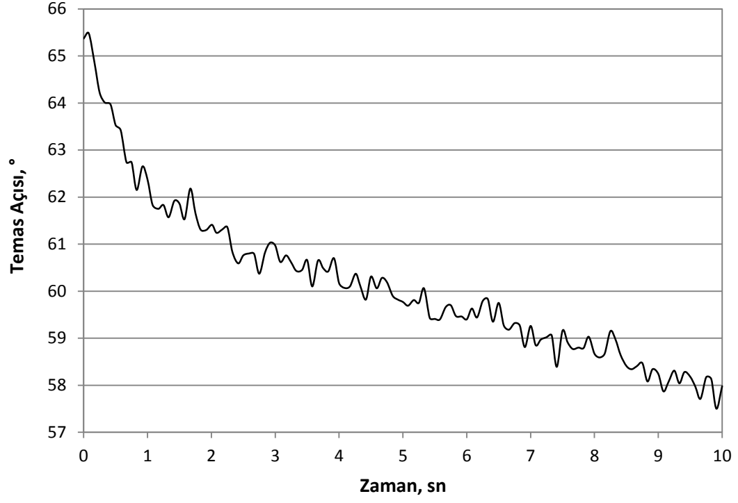
Şekil 6.24 Kirli UP150 membranının temas açısı ölçümü
