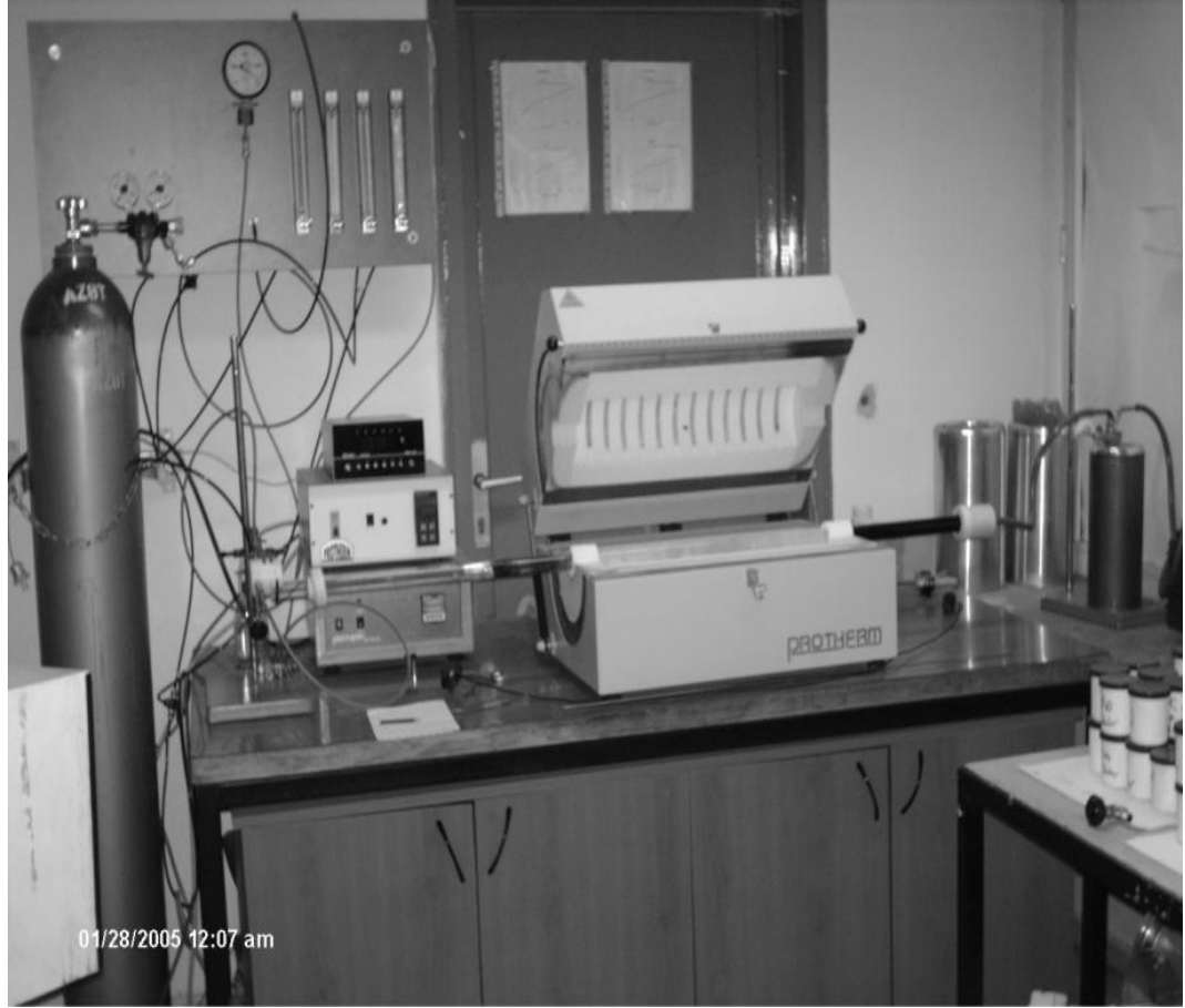
Şekil 4.1 Tez çalışmasından önce laboratuvarımızda kurulu olan CVD sisteminin fotoğrafı (Soysal 2009)
