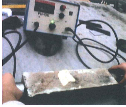
Şekil 3.9. Ultrases geçiş hızı deneyi
