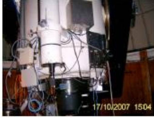
Şekil 3.1: 84 cm ayna çaplı Ritchey-Chrétien teleskobu.
