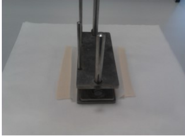
Şekil 7.11: Yağ lekeli kumaş ağırlık altında bekletilir.
