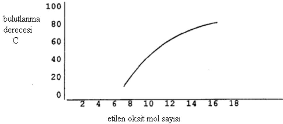
Şekil 5.12: Etilen oksit mol sayısı ile bulutlanma noktası arasındaki ilişki.
