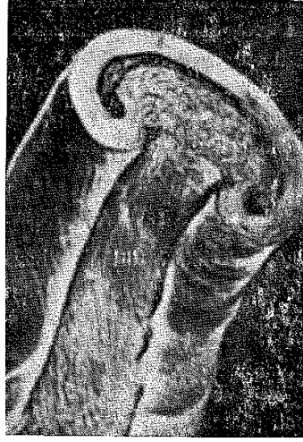
Şekil 2.1: Pamuk lifinin yapısı.
