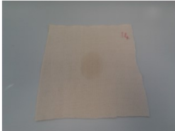
Şekil 7.12: Isıl işlem (fikse) sonrasında lekenin büyüdüğü gözlemlenir.
