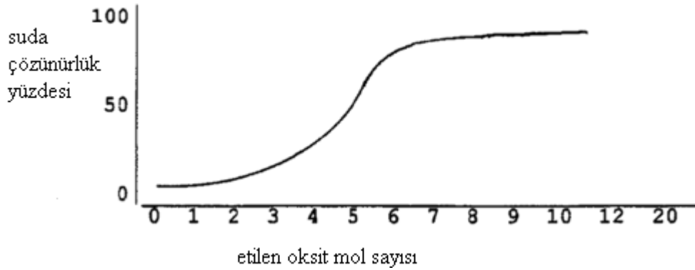
Şekil 5.11: Etilen oksit mol sayısına bağlı olarak suda çözünürlüğün değişimi.
