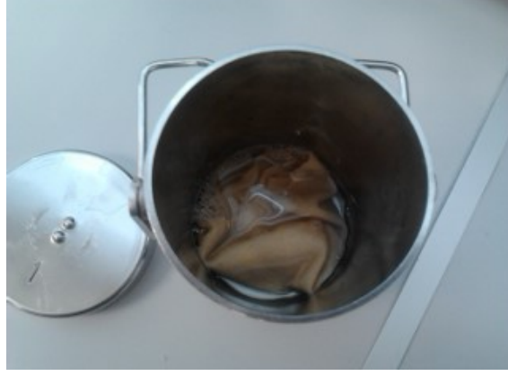
Şekil 7.14: Kumaşı ve solüsyonu, yıkama makinasına ait tüp içine yerleştirme.
