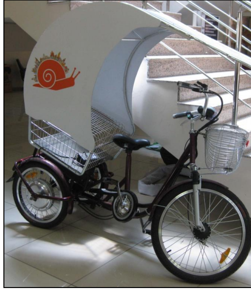
Şekil 6.29 : Seferihisar Belediyesi için Metalürji Yüksek Mühendisi Rıdvan Bazman'ın yaptığı güneş panelli bisiklet (Hocaoğlu, 2010).
