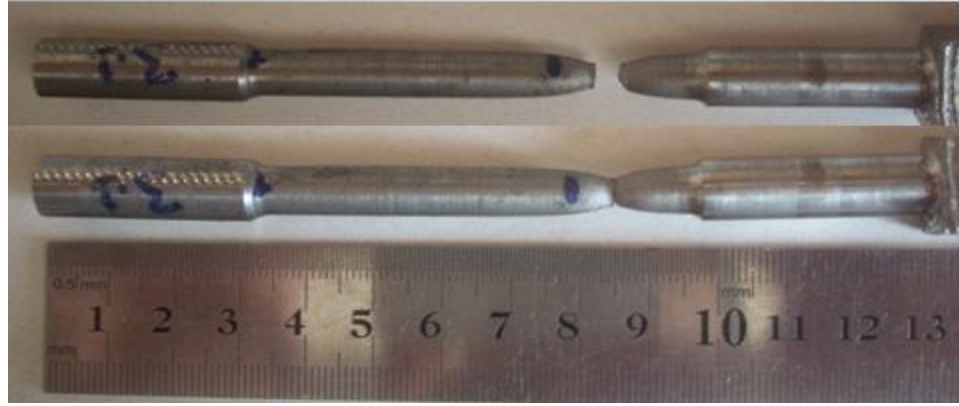
Şekil IV.16 3 No'lu Parçanın 1. Tamiri Çekme Sonrası Görünümü
