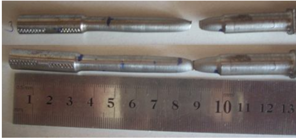
Şekil IV.6 3 No’lu Numunenin Çekme Sonrası Görünümü
