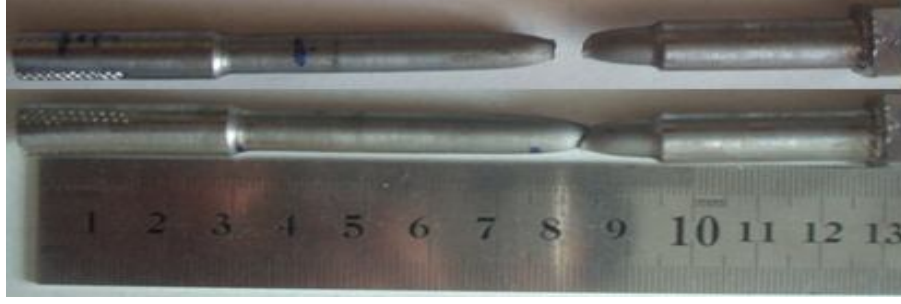
Şekil IV.20 4 No'lu Parçanın 1. Tamiri Çekme Sonrası Görünümü
