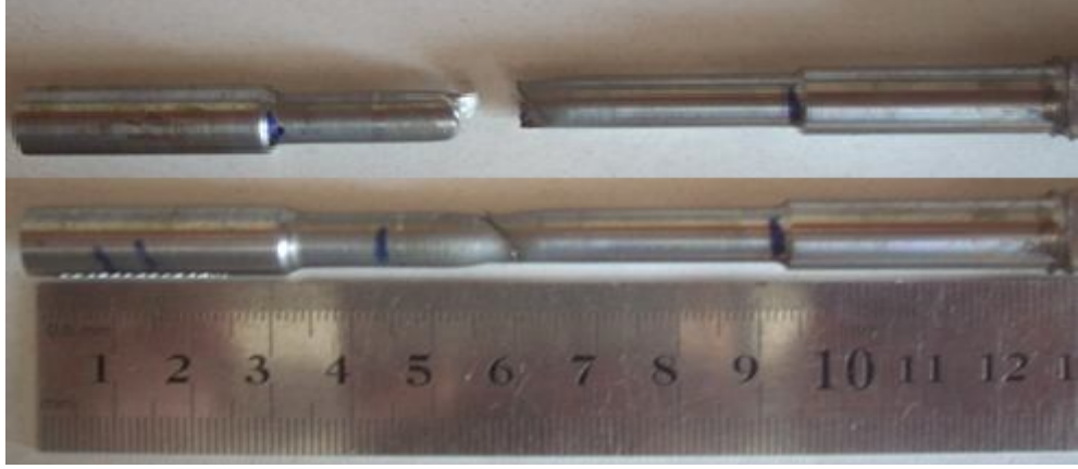
Şekil IV.8 1 No'lu Parçanın 1.Tamiri Çekme Sonrası Görünümü
