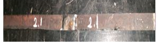
Şekil III.26 2 No'lu Parçanın 1.Tamiri Çekme ve Metalografi Numuneleri
