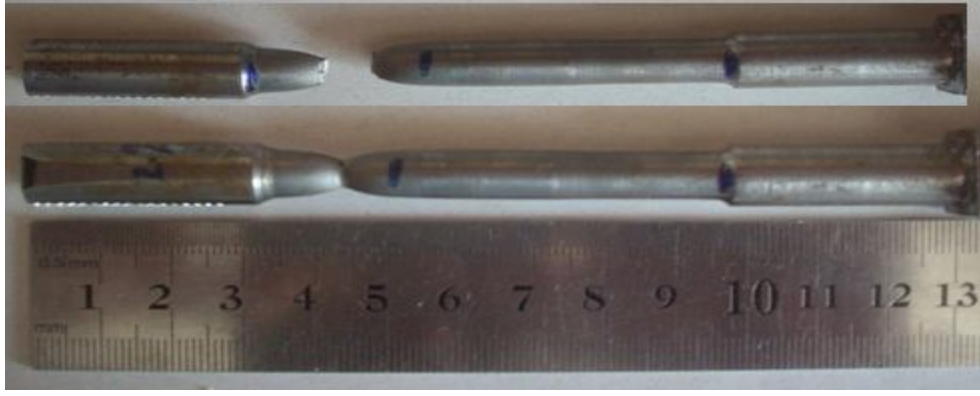
Şekil IV.14 2 No'lu Parçanın 2. Tamiri Çekme Sonrası Görünümü
