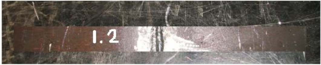
Şekil III.21 1 No'lu Parçanın 1. Tamiri Çekme ve Metalografi Numuneleri
