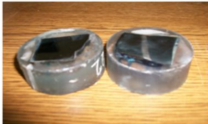
Şekil III.55 Numunelerin Soğuk Kalıplanması ve Kalıp Ölçüleri
