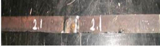
Şekil III.26 2 No'lu Parçanın 1.Tamiri Çekme ve Metalografi Numuneleri
