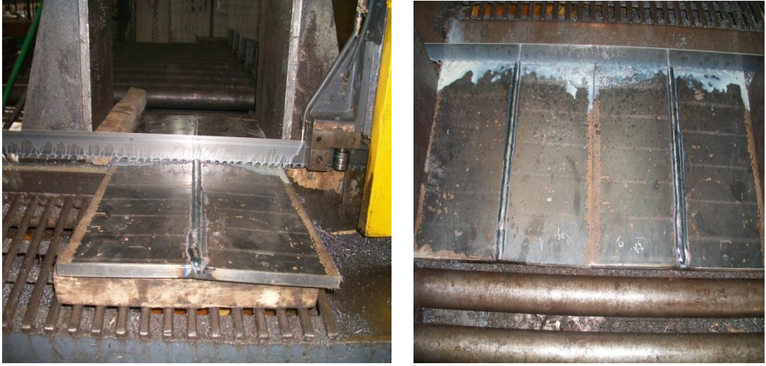
Şekil III.8 Kaynaklı Plakaların 2 Eşit Parçaya Bölünmesi
