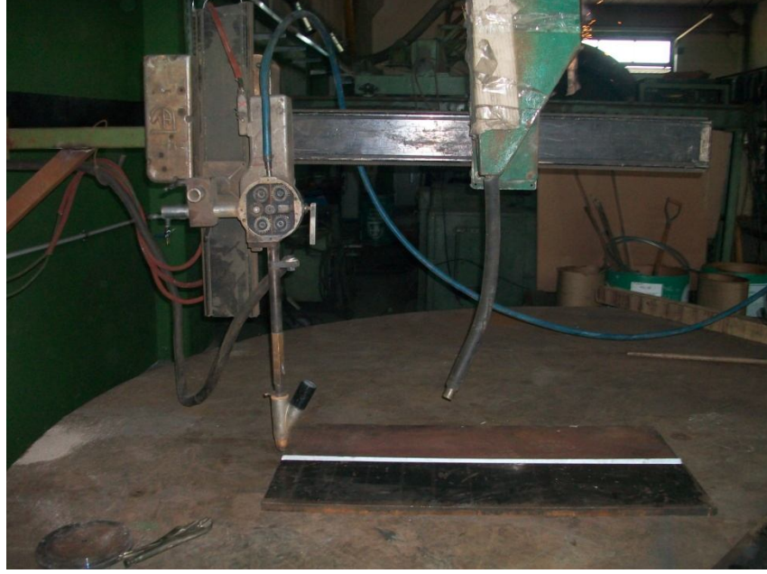
Şekil III.5 Plakaların Tozaltı Kaynak Yöntemi ile Birleştirilmesi
