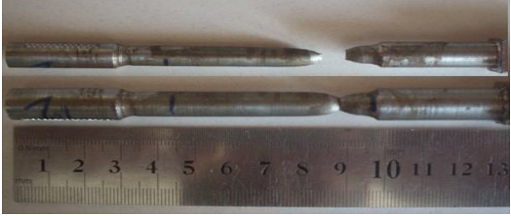
Şekil IV.10 1 No'lu Parçanın 2. Tamiri Çekme Sonrası Görünümü
