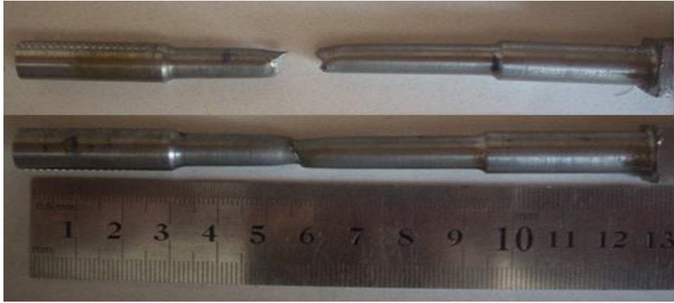
Şekil IV.12 2 No’lu Parçanın 1. Tamiri Çekme Sonrası Görünümü
