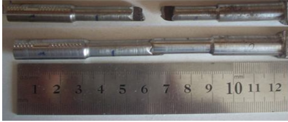
Şekil IV.4 2 No'lu Numunenin Çekme Sonrası Görünümü
