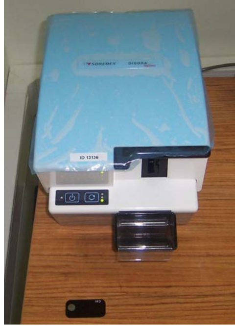
Şekil 3.6. Dişlerin yarı direkt dijital görüntülerini elde etmek için kullanılan Digora Optime cihazı.
