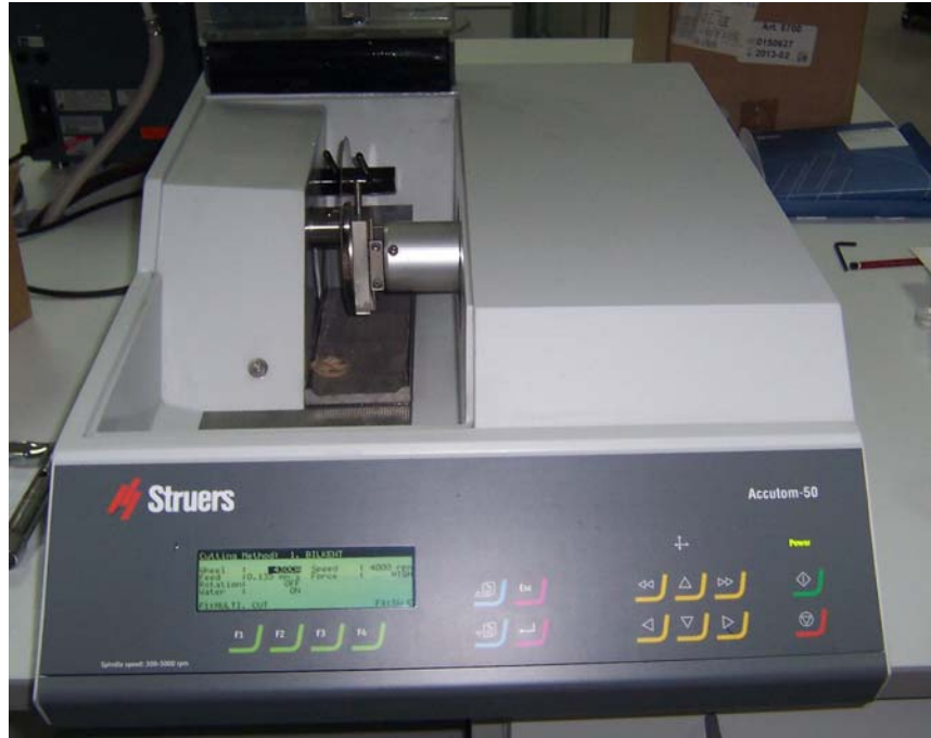
Şekil 3.11. Histolojik kesitleri hazırlamak için kullanılan Accutom-50 (Struers, Denmark) hassas kesim cihazı.
