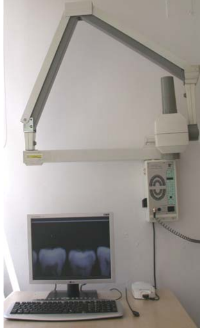
Şekil 3.4. Diş bloklarının DDR görüntülerini elde etmek için kullanılan CCD sensörlü dijital görüntüleme sistemi.
