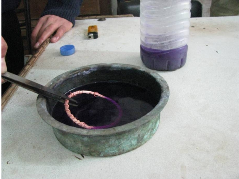
Resim 52 Altın Teli Balmumuna Batırma İşlemi
