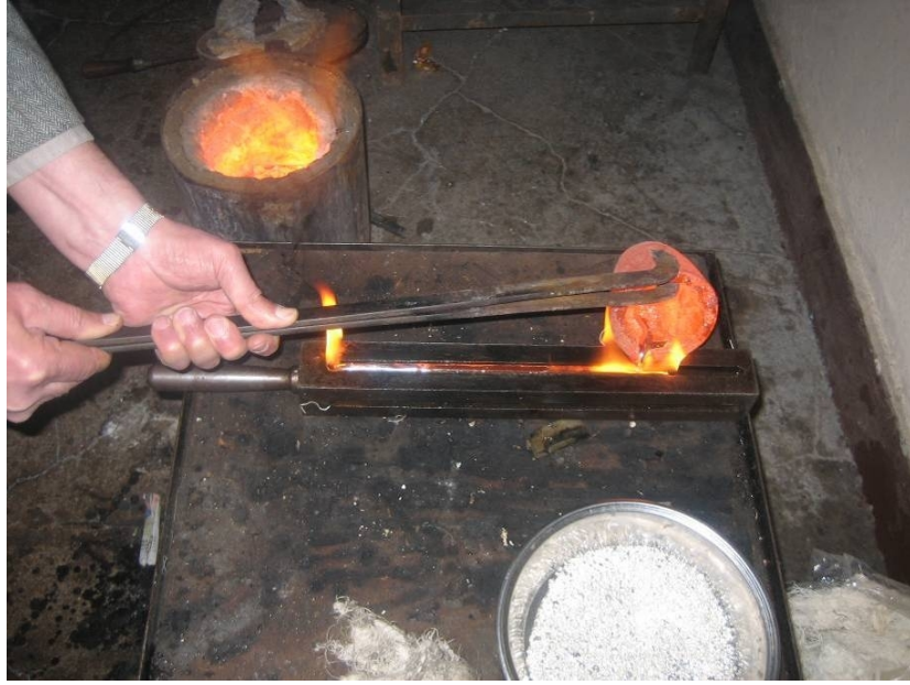
Resim 43 Eritilen Altının Rizeğe Dökülmesi 2
