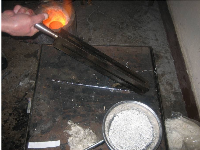
Resim 44 Altın Çubuğun Rizekten Çıkarılma İşlemi
