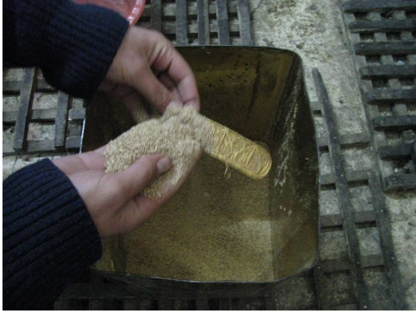
Resim 63 Testere Talaşına Batırma İşlemi
