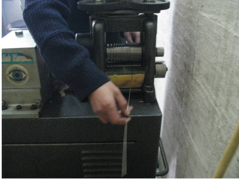
Resim 46 Altın Çubuğun İnceltme Silindirinden Geçirme İşlemi
