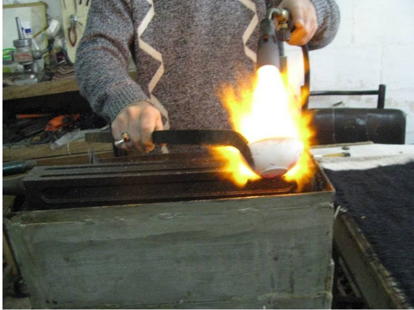
Resim 42 Eritilen Altının Rizeğe Dökülmesi 1
