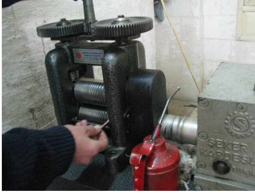
Resim 45 Altın Çubuğu Oluklu Silindirden Geçirme İşlemi
