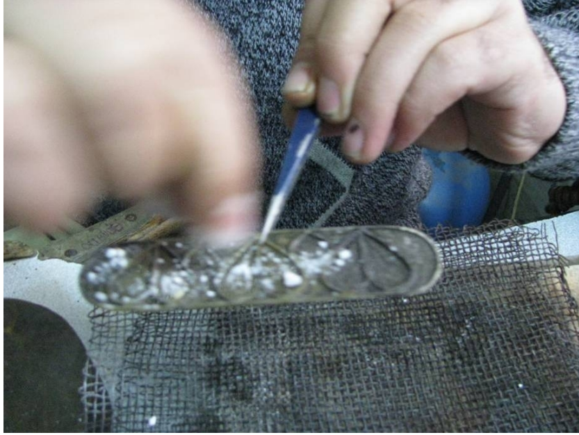
Resim 58 Kaynak Aşamasında Sürülen Toz Eriyik
