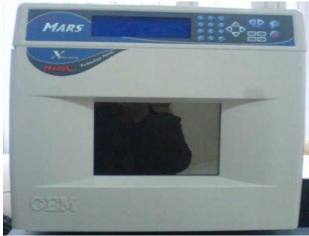
Şekil 6.1. Mikrodalga çözünürleştirme sistemi.
