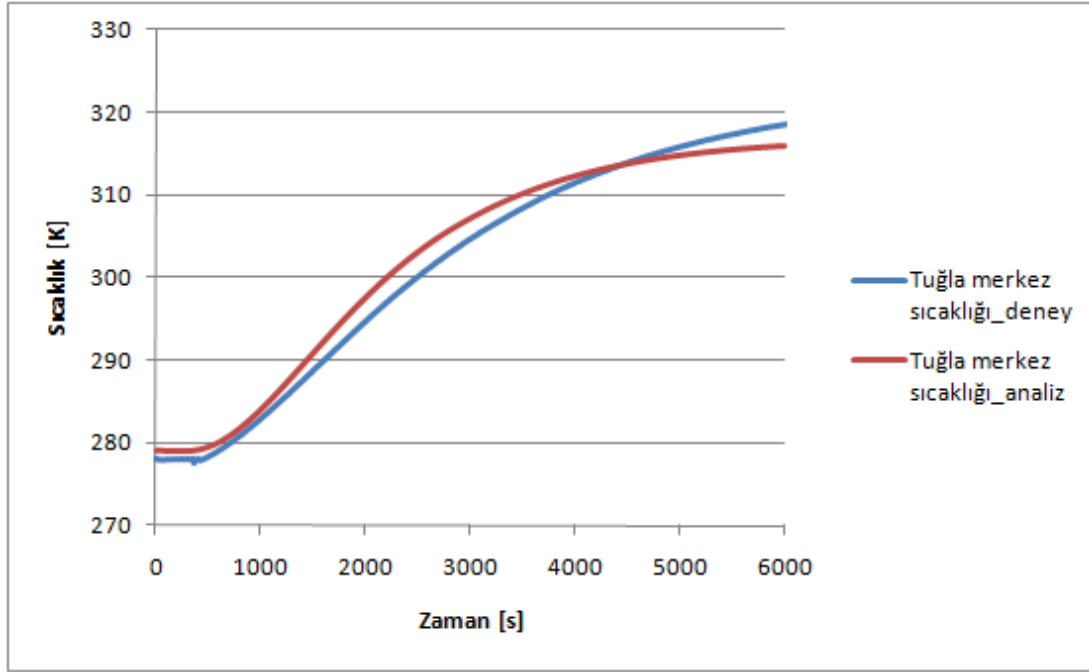
Şekil 4.19: Tuğla merkez sıcaklığının 12 mm baca çapı için karşılaştırması .
