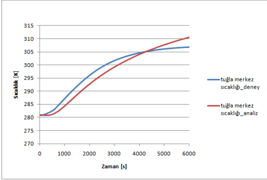
Şekil 3.25: Tuğla merkez sıcaklığının deneysel ve sayısal karşılaştırması.
