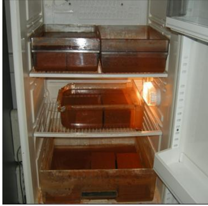
Şekil 3.3: Tuğlaların soğuk suda bekletilmesi.
