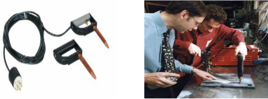
Şekil 1.19.Manyetizasyon meydana getiren prodlar ve manyetizasyon işlemi
