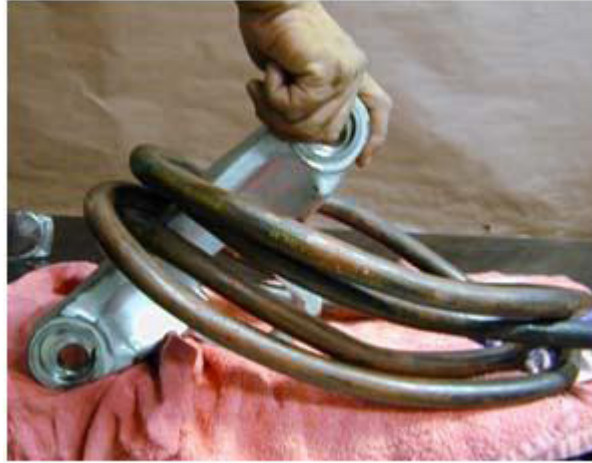
Şekil 1.18. Bağlantılı bobin ile manyetizasyon
