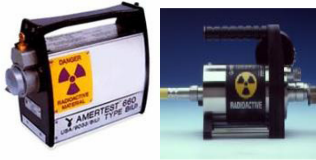
Şekil 1.49. Uzaktan kumanda edilen gama ışın tüpü ve elde taşınabilen gama ışın tüpleri
