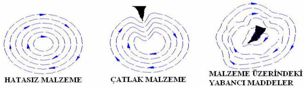
Şekil 1.29.Malzemeler üzerinde çatlak ve yabancı madde etkisi
