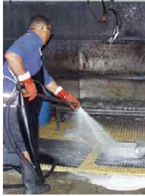
Şekil 1. 7. Malzeme üzerindeki Penetrantın temizlenmesi ve developer(geliştirici) uygulaması
