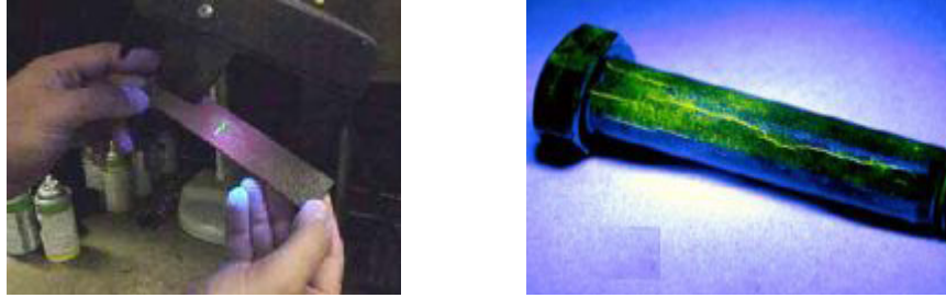
Şekil 1. 9. Malzemenin beyaz ışık altında kontrol edilmesi
