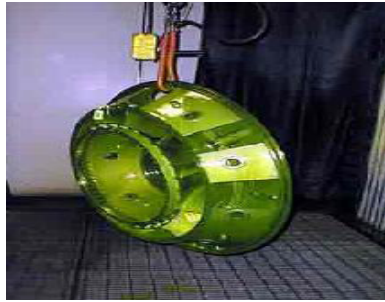
Şekil 1. 8. Malzemenin developer (geliştirici) uyguladıktan sonra kurutulması
