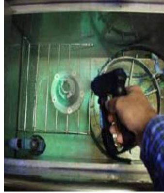
Şekil 1. 7. Malzeme üzerindeki Penetrantın temizlenmesi ve developer(geliştirici) uygulaması
