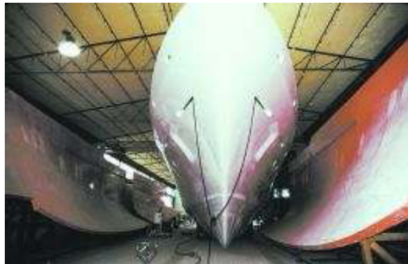
Şekil 3.22 : Megayat karinası kalıptan ayrılıyor.
