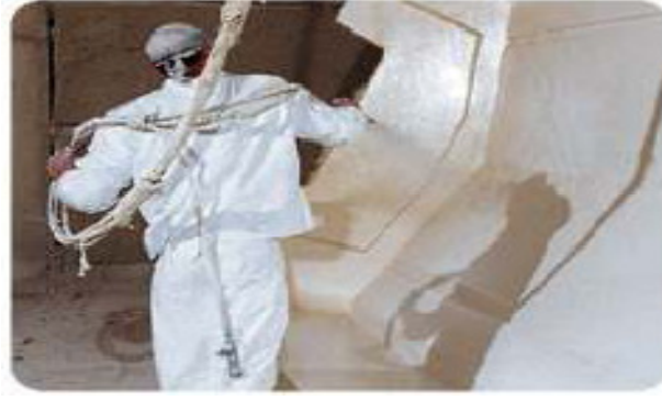
Şekil 3.18 : Sea Pro marka bir motoryatta püskürtme işlemi.
