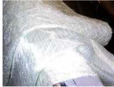
Şekil 3.12 : Kumaş haline getirilmiş cam elyafı.
