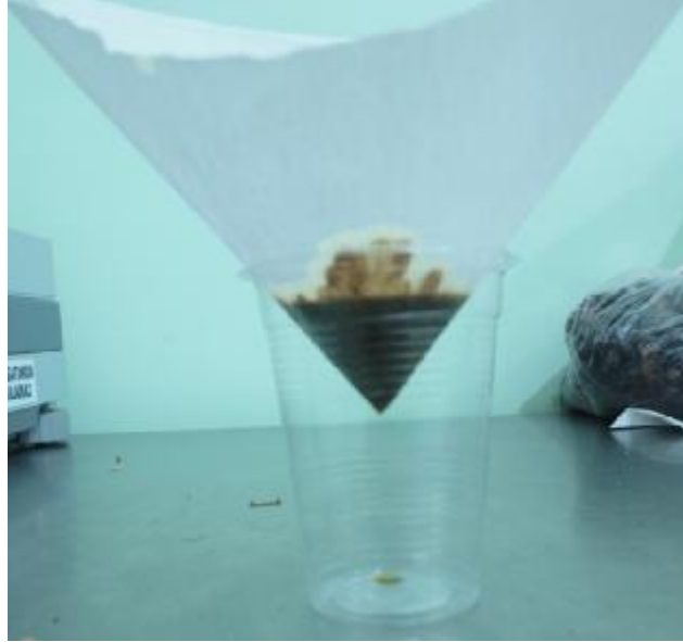
Şekil 3.19. Vidalı preste sıkılan ve katı faz içeren yağın filtre edilmesi
