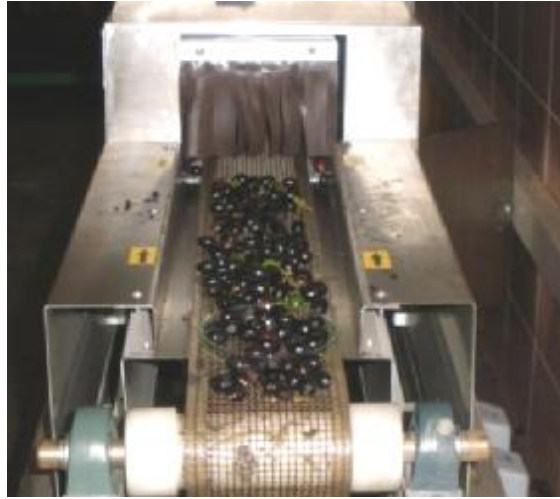
Şekil 3.13. Ürünün bant üzerine ince tabaka şeklinde serilmesi
