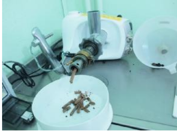
Şekil 3.17. Defne meyvesinin vidalı presle sıkılması
