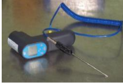
Şekil 3.8. Kızılötesi sıcaklık ölçer ve probu
