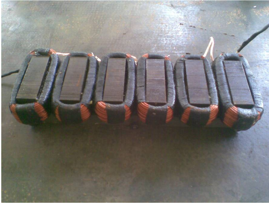
Resim 6.3. Bobinlerin translatora yerleştirilmesi
