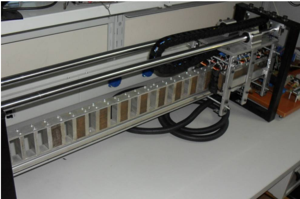
Resim 6.5. Çift taraflı lineer anahtarlama relüktans motor
