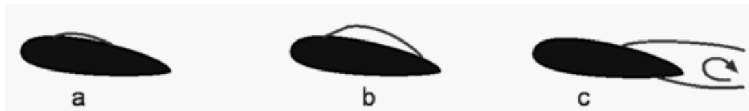
Şekil 1.5. Kanat profil etrafında değişik bölgelerde oluşan laminer ayrılmalar [7].
