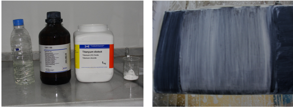
Şekil 2.30. Yağ deneyi için kimyasal maddeler ve karışımın kanat üst yüzeyine sürülmüş hali.
