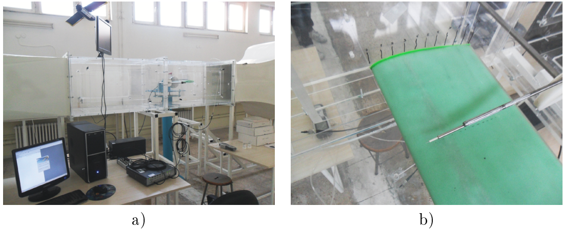
Şekil 2.43. a) Tünelde sabit sıcaklık anemometresi, b) kanat üzerinde prob.
