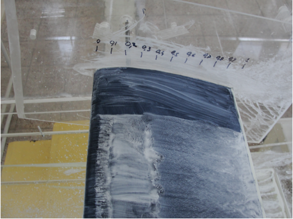
Şekil 2.33. Kanat profili üst yüzeyinde yağ deneyi sonucu ( Re=1 \times 10^5 , \alpha=12^\circ ).
