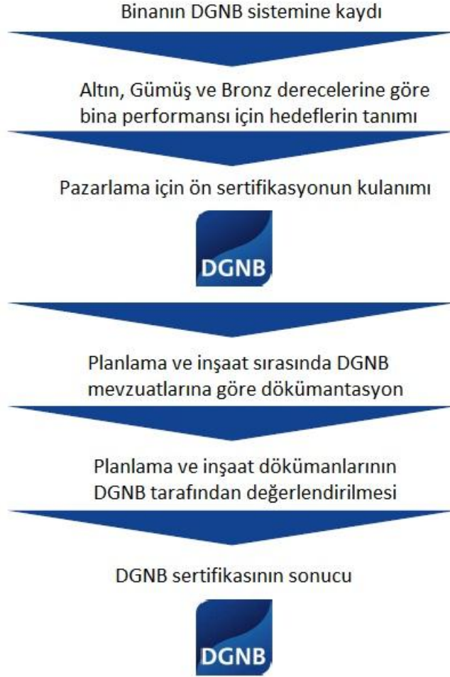
Şekil III.6 Bir Binanın DGNB Sistemi ile Derecelendirilme Süreci
