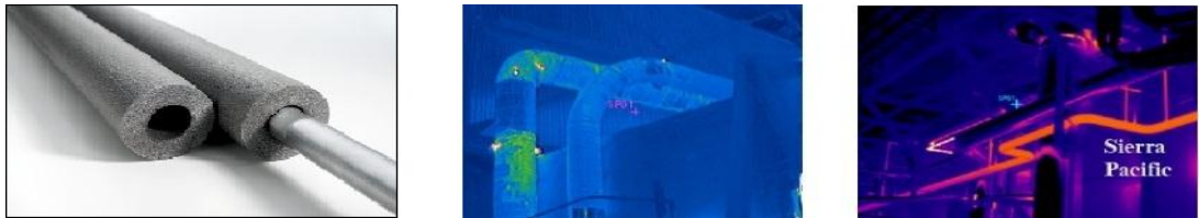
Şekil II.8 Boru yalıtımı ve termal görüntüleri
