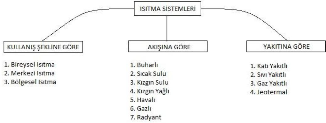
Şekil II.10 Isıtma sistemlerinin sınıflandırılması[26]
