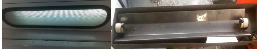
Resim 5.7: Vagon sahanlık aydınlatma armatürü ve içyapısı
