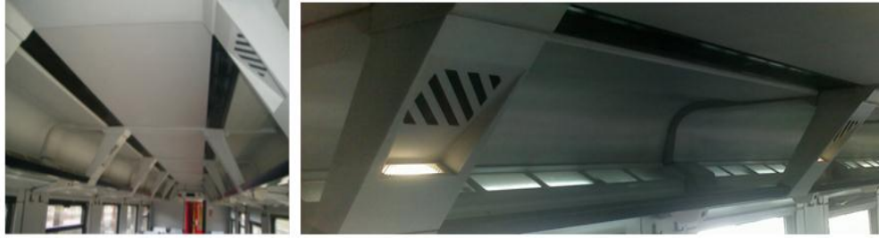
Resim 5.1: TVS 2000 Pulman Vagon salon aydınlatması (24 V DC ve 220 V AC)
