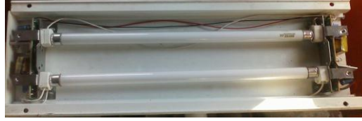
Resim 5.10: Vagon tuvalet aydınlatma armatürü içyapısı
