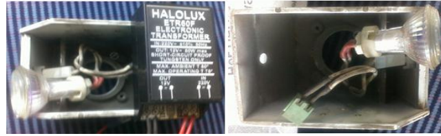
Resim 5.13: Okuma armatürü içyapısı ve transformatör
