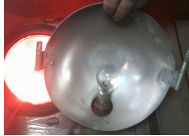
Resim 5.11: Vagon son ışıklarında kullanılan armatür yapısı ve akkor lamba
