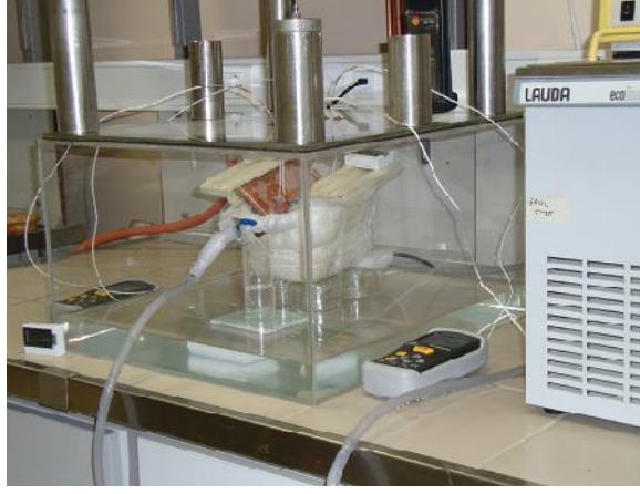
Şekil 6.8. Bakır hücreyle su toplama denemelerinin gerçekleştirildiği deney düzeneğinin fotoğrafı.
