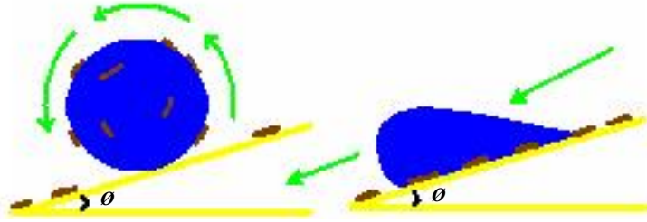
Şekil 2.6. Kayma açısının şematik gösterimi.
