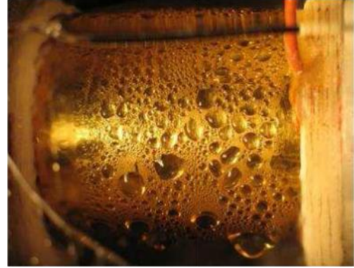
Şekil 4.3. Yatay bir tüp üzerinde meydana gelen damla tipi kondensasyon [Vemuri, 2005].
