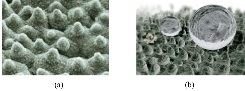
Şekil 2.7. a) Lotus yaprağının SEM görüntüsü (Bar: 20 \mu m) [Barthlott and Neinhuis, 1997]. b) Lotus yaprağı yüzeyinin bilgisayar grafiği.
