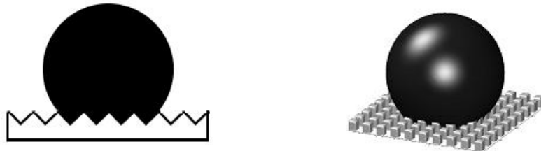
Şekil 2.9. Wenzel modeline göre pürüzlü bir yüzey üzerindeki sıvı damlası.
