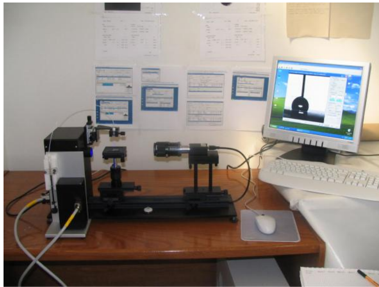
Şekil 6.3. KSV CAM 200 temas açısı ölçüm cihazı.
