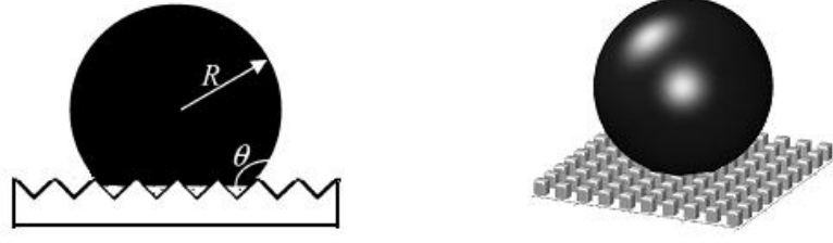
Şekil 2.10. Cassie-Baxter modeline göre pürüzlü bir yüzeydeki sıvı damlası.
