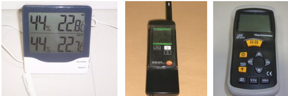
Şekil 6.10. Denemelerde kullanılan termohigrometre ve termometreler.
