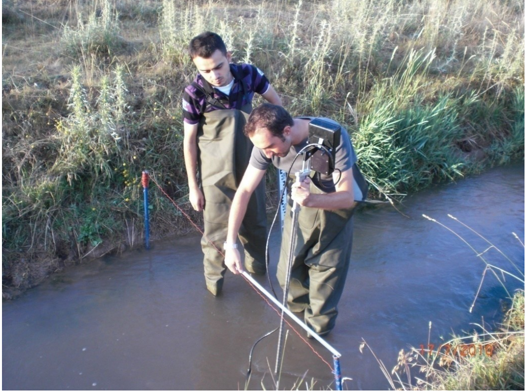
Şekil 3.19. Özvatan Kırıközü İstasyonu hız ölçümü.
