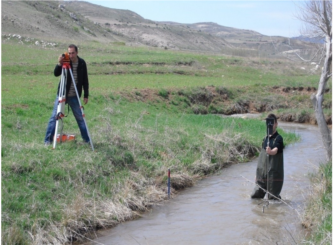
Şekil 3.20. Özvatan Kırıközü İstasyonu hız ölçümü ve boy kesit çıkarılması.
