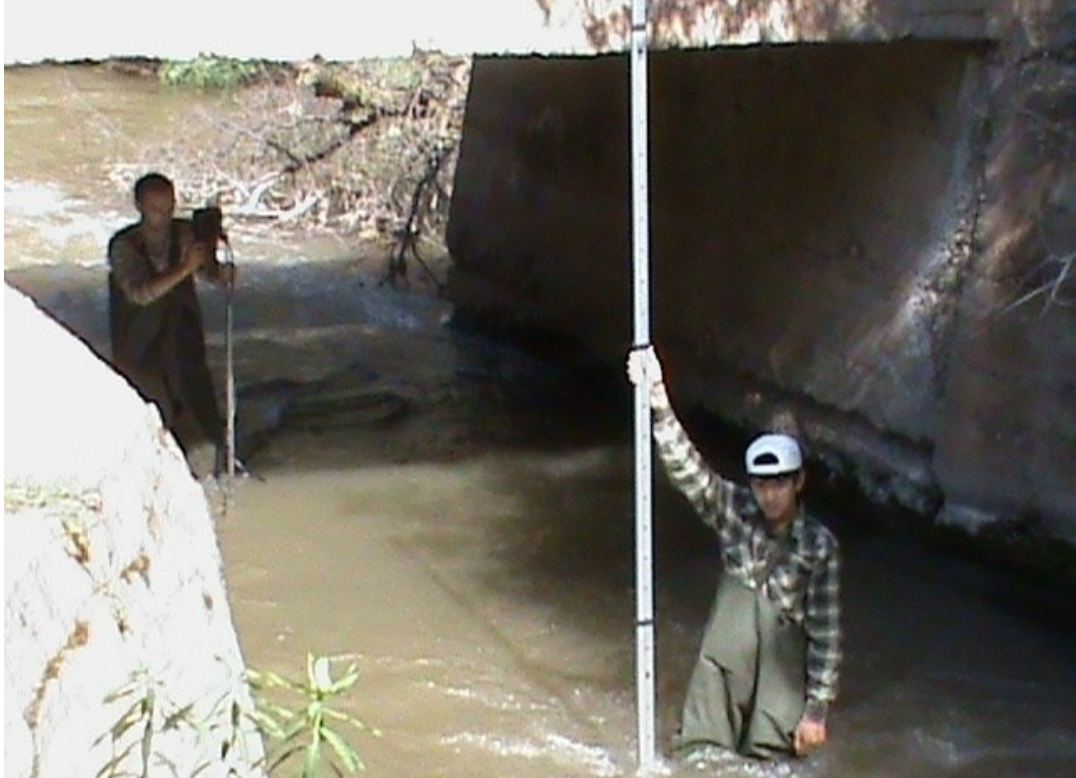
Şekil 3.9. Sarımsaklı Baraj Girişi İstasyonu hız ölçümü ve boy kesit çıkarılması.
