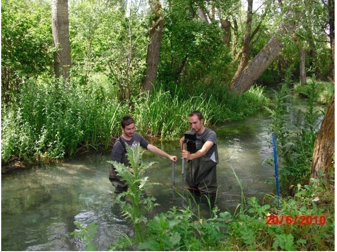
Şekil 3.2. Bünyan Pınarbaşı İstasyonu hız ölçümü çalışmaları.
