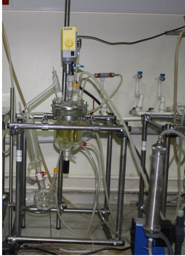
Şekil 3.3: Atık Ağartma Toprağından yağ kimyasalları üretim sistemi.
