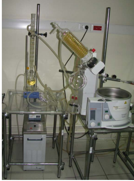
Şekil 3.1: AAT yağının çözücüsüz ortamda metanol ile alkoliz reaksiyon sistemi.
