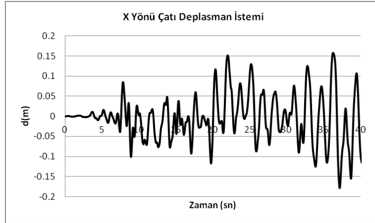
Şekil 5.31 P0170 Imperial Valley depremi X doğrultusu tepe yatay yerdeğiştirme-zaman grafiği
