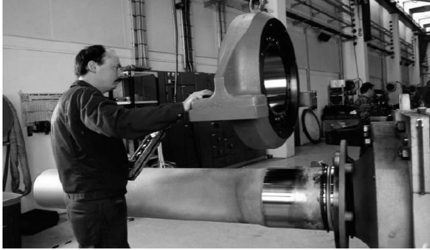
Şekil 2.1. Montajdan önce düşük hızlı şaft (mil) ön rulmanı yataklanması [1].
