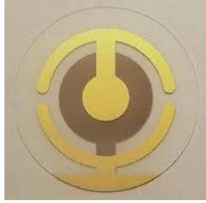
Şekil 2-5 Sıvı uygulamalarında kullanılan kuartz kristal mikrobals transduser görünümü
