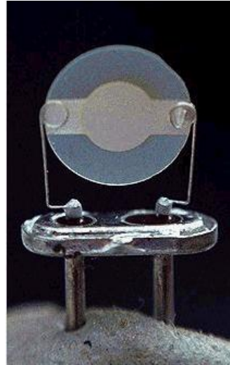
Şekil 2-4 Gaz uygulamalarında kullanılan kuartz kristal mikrobalsans transduser görünümü
