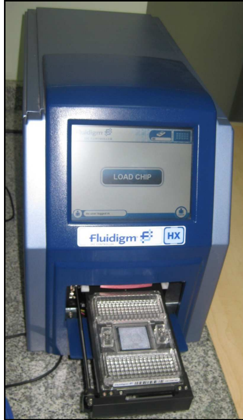
Resim 3.2. Fluidigm IFC Controller HX cihazına çipin yerleştirilmesi
