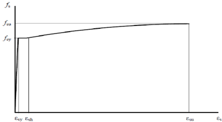
Şekil 3.3 : Donatı çeliğinin gerilme-şekil değiştirme bağıntısı.
