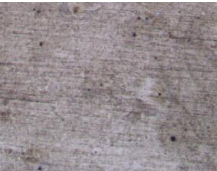
Şekil 6.5.1.2550 püskürtme nozulının mikroyapısı(50 kere büyütülm)
