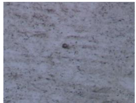
Şekil 6.7.1.2550 püskürtme nozulının mikroyapısı.(500 kere büyütülmüş. )
