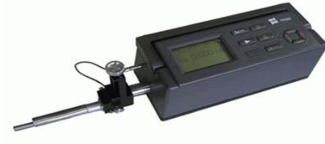
Şekil 5.12. Yüzey pürüzsüzlük deneyinin yapıldığı cihaz
