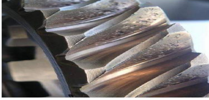
Şekil 1.9. Sonsuz Dişlideki Yorulma Aşınması (Vikipedi, 2008).
