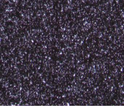
Şekil 6.4.1.2379 püskürtme nozulının mikroyapısı (50 kere büyütülmüş)
