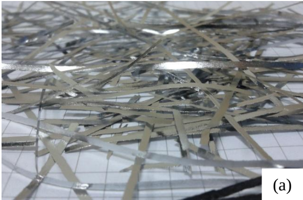
Şekil 3.4. Aynı eriyik döndürme sisteminde üretilen farklı kompozisyonlara sahip şerit alaşımlar: (a) (Al_{85}Y_8Co_7)_{98}Cu_2 şerit alaşımı ve (b) Al_{85}Y_5Co_5Ni_5 şerit alaşımı
