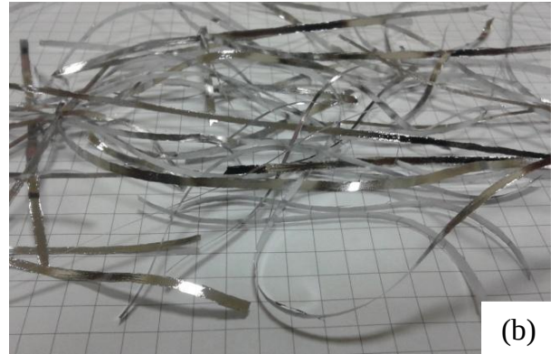
Şekil 3.4. Aynı eriyik döndürme sisteminde üretilen farklı kompozisyonlara sahip şerit alaşımlar: (a) (Al_{85}Y_8Co_7)_{98}Cu_2 şerit alaşımı ve (b) Al_{85}Y_5Co_5Ni_5 şerit alaşımı
